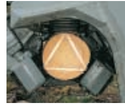
El sistema de medición triangular de Ponsse tiene en cuenta incluso la posible forma oval del tronco. El diámetro se mide con precisión de milímetros.
